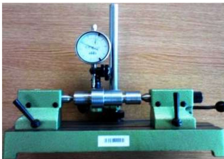
25. ábra. Lépcsős tengely radiális ütész vizsgálata mérőórával
