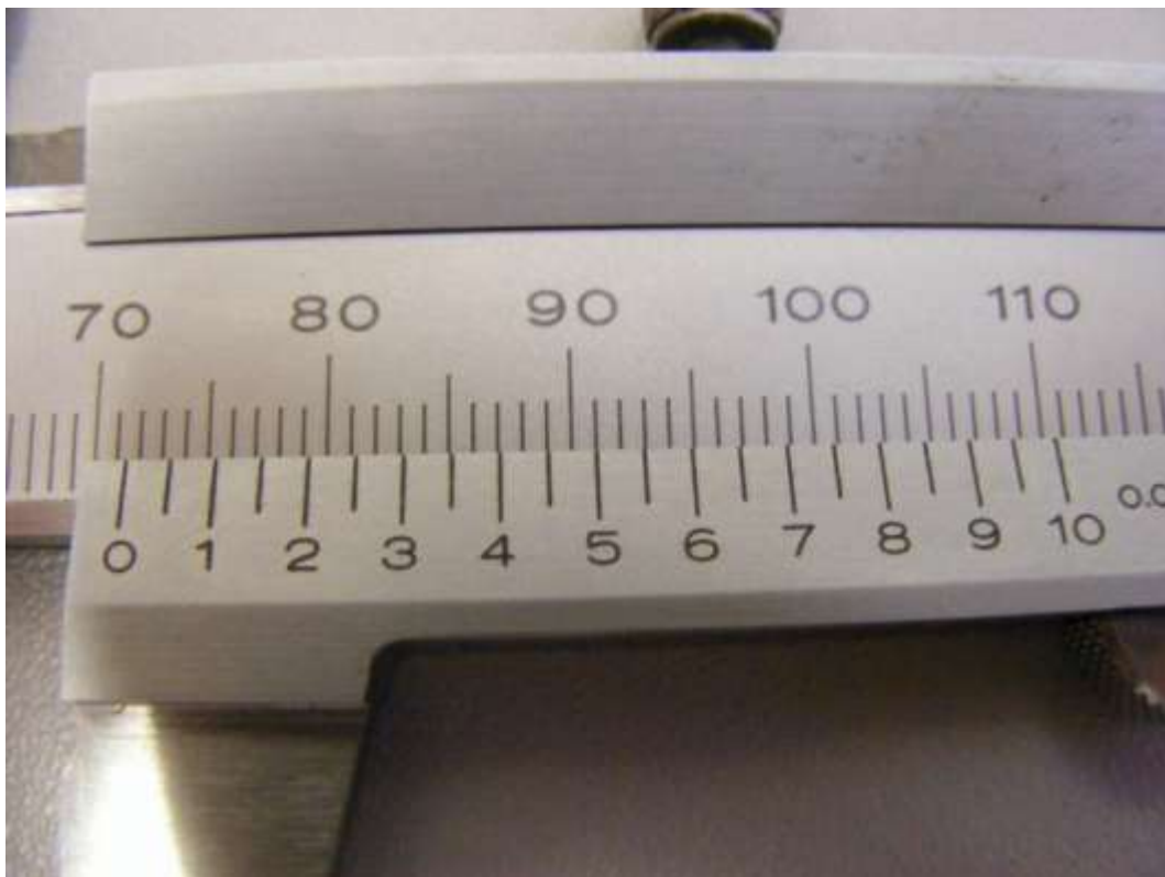
5. ábra. A 0,05\text{mm} -es leolvasási pontosságú tolómérő nóniusz osztása
