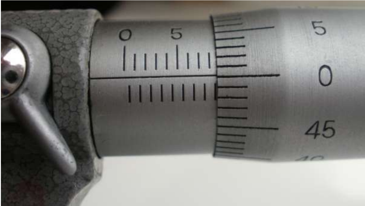
18. ábra. A mikrométer nóniuszosztása
