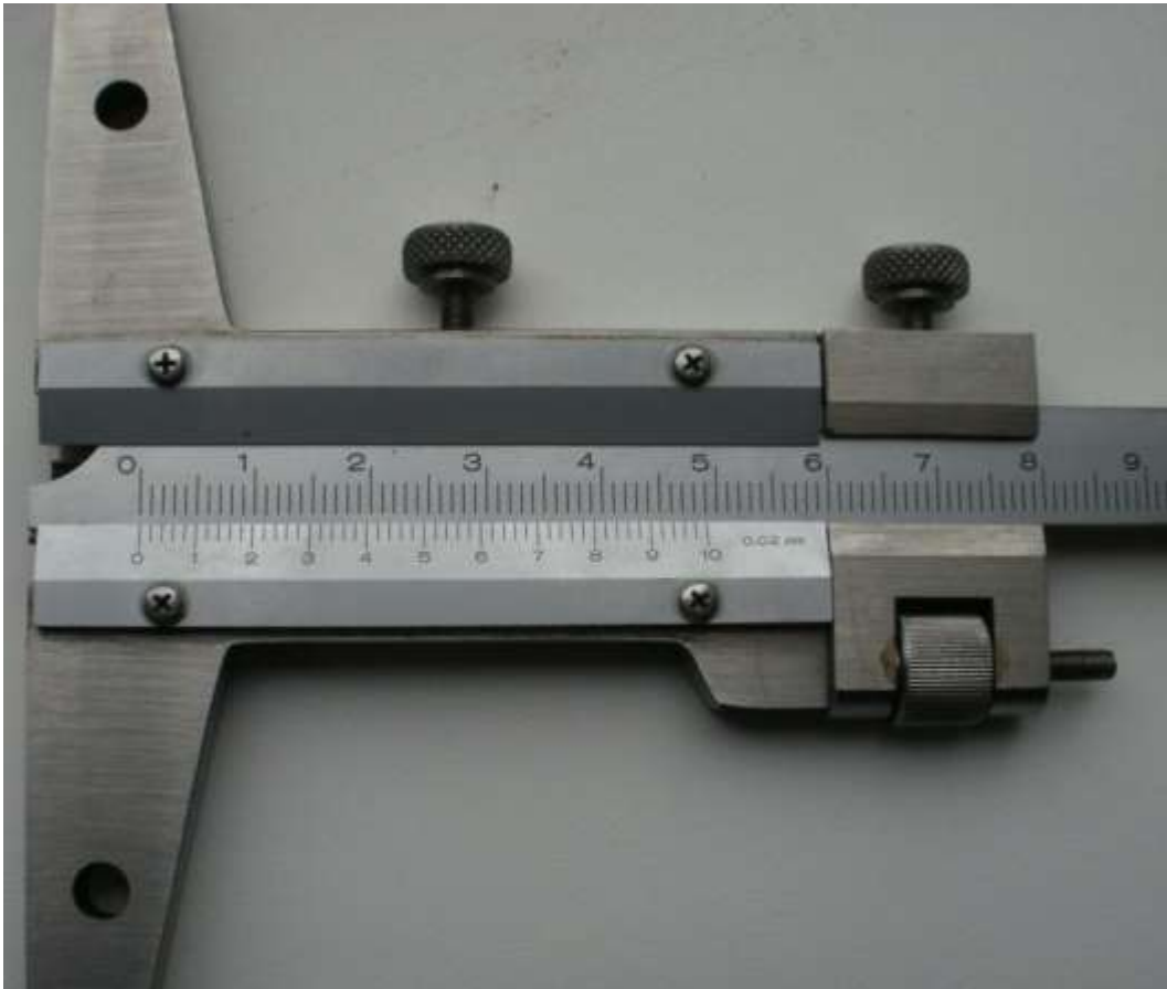
6. ábra. A 0,02 \text{ mm} -es leolvasási pontosságú tolómérő nóniusz osztása
