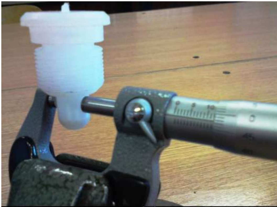
20. ábra. Külső felület mérése mikrométerrel
