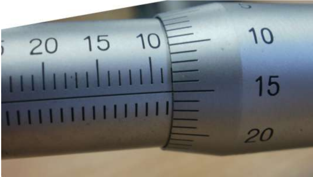
19. ábra. Mélységmérő mikrométer nóniusz osztása
