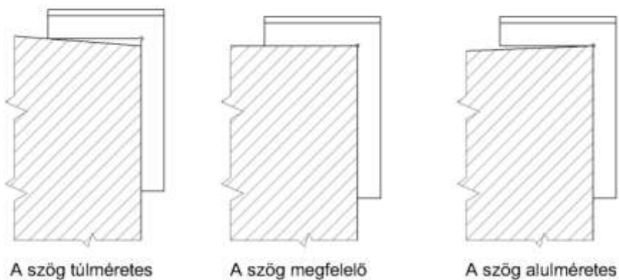
22. ábra. Ellenőrzés derékszöggel
